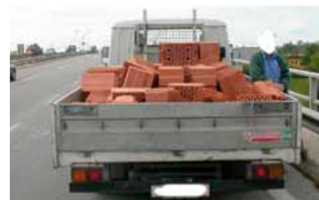
Verlust einer Palette Ziegel bei einer normalen Kurvenfahrt. Relevante Faktoren: keine Ladungssicherung und zu hohe Fahrgeschwindigkeit
