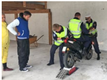
Beamte der API-Schönberg LVA bei der Überprüfung der Bauartgeschwindigkeit.
