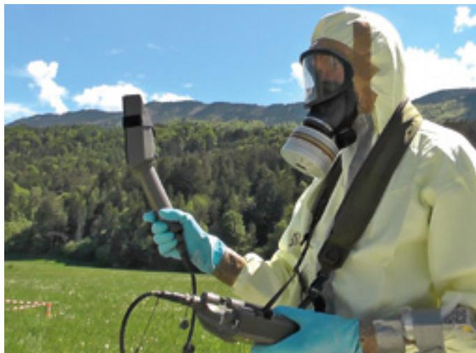
Verwendung des SSM-1 mit Kontaminationssonde „ASPECT“.
