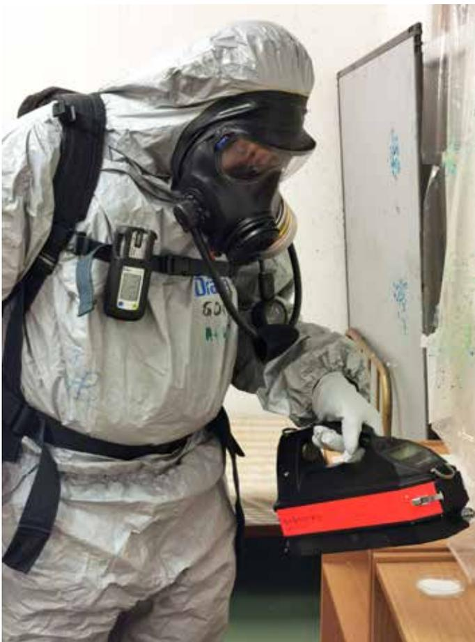
GKO im Einsatz mit dem „Gas Detector Array“ (GDA) beim Messen luftgetragener Schadstoffe
