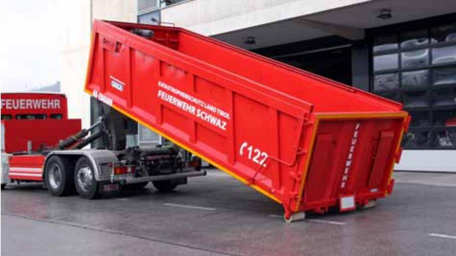
Der Abrollbehälter wird mit einem Wechselladerfahrzeug zum Einsatzort gebracht.
