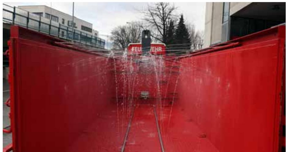
Innenansicht des Containers mit Sprühvorrichtung
